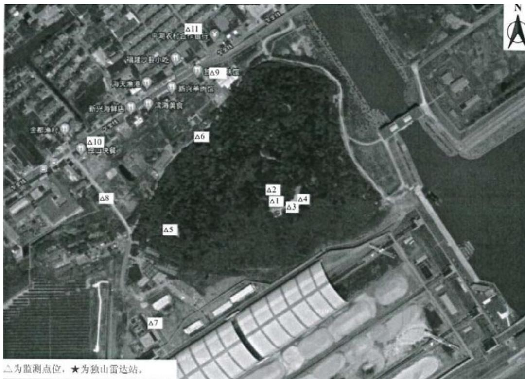
图4.4-1 独山雷达站电磁辐射环境监测布点示意图
